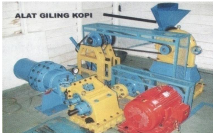
Gambar 2.2 Turbine yang sekaligus menggerakkan mesin giling kopi Pada PLTMH Silayang Pasaman, Sumatera Barat
