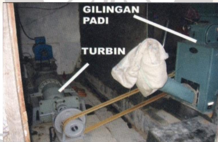
Gambar 2.1 Turbine yang sekaligus menggerakkan mesin penggilingan padi.
