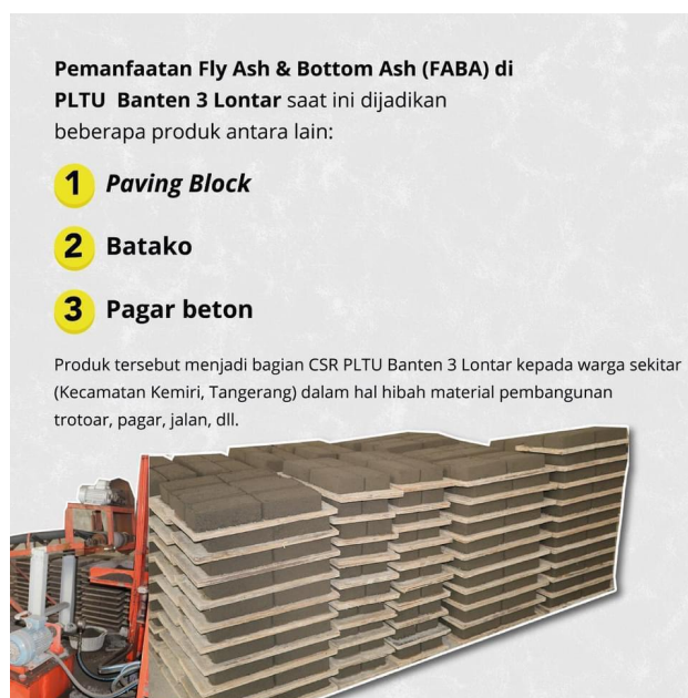
Gambar 2.6 Pemanfaatan Fly Ash & Bottom Ash (FABA) di PLTU Banten 3 Lontar Sumber : Ruangenergi.com
