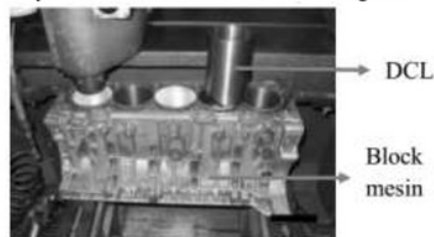
Gambar 1. DCL yang akan dipasang pada block mesin ( http://www.automotive-services.co.uk/service-menu/cylinder-reboring-sleeving/ )
