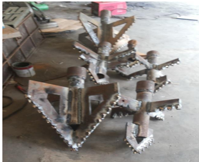
Gambar 2.6. Mata bor Cross bit dengan Mata Pisau Widia (Dokumentasi Pribadi)
