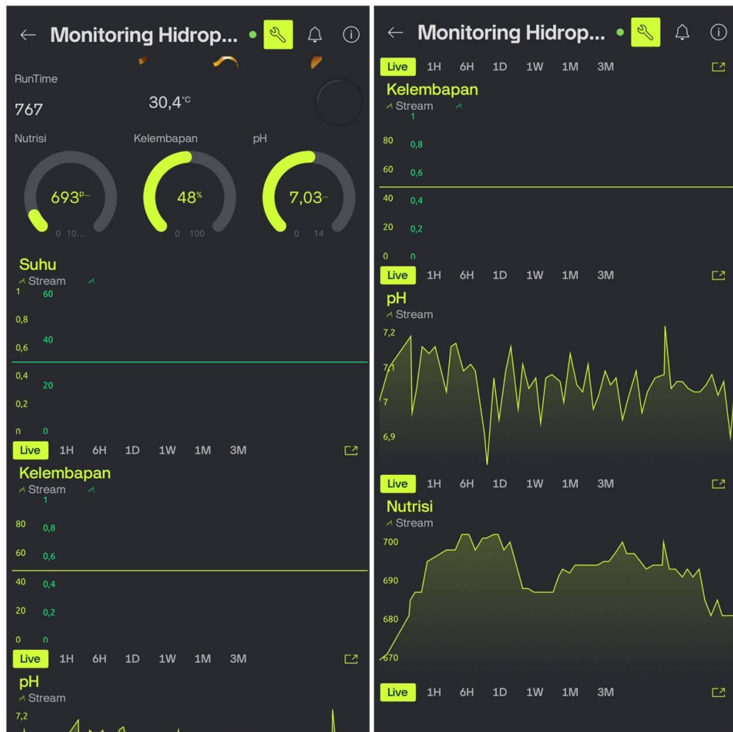
Gambar 4. 13 Tampilan Dashboard Blynk pada Aplikasi Mobile
