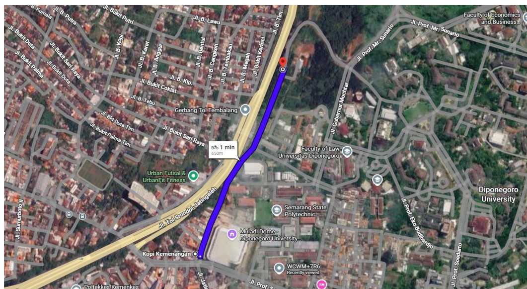
Gambar 5. 1 Tempat dan jarak Pengujian RSSI LoRa
