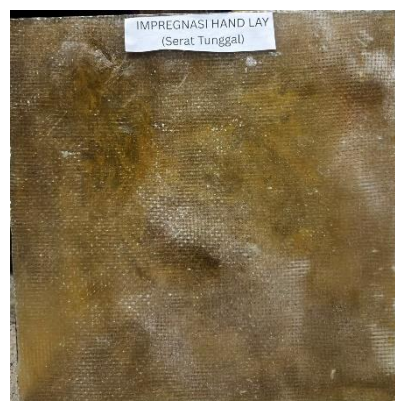
Gambar 4.2 Hasil komposit serat fiberglass dengan metode impregnasi hand lay
