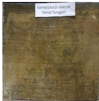
Gambar 4.1 Hasil komposit serat fiberglass dengan metode impregnasi vakum
