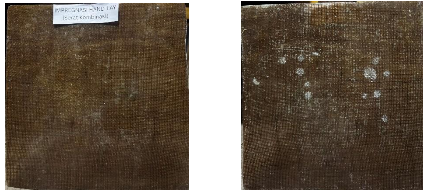
Gambar 4.3 Hasil komposit kombinasi serat sisi 1 (gambar kiri) dan sisi 2 (gambar kanan) dengan metode impregnasi hand lay
