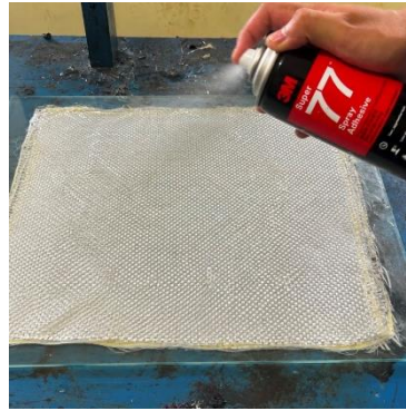
Gambar 3.27 Penyemprotan spray adhesive
