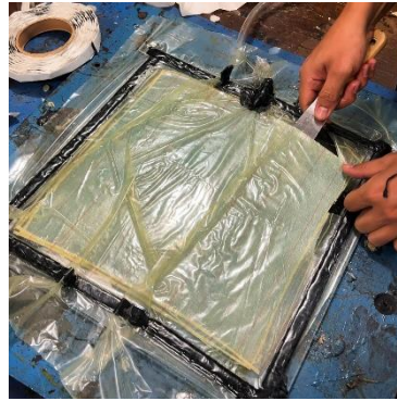
Gambar 3.46 Pelepasan komposit dari cetakan
