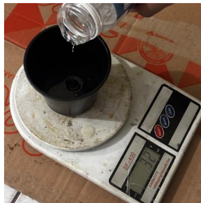
Gambar 3.41 Peracikan resin dan hardener
