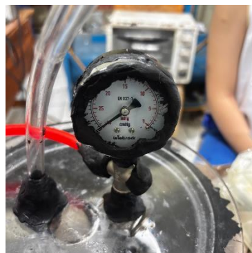
Gambar 3.30 Pressure gauge menunjukan angka 76 cmHg
