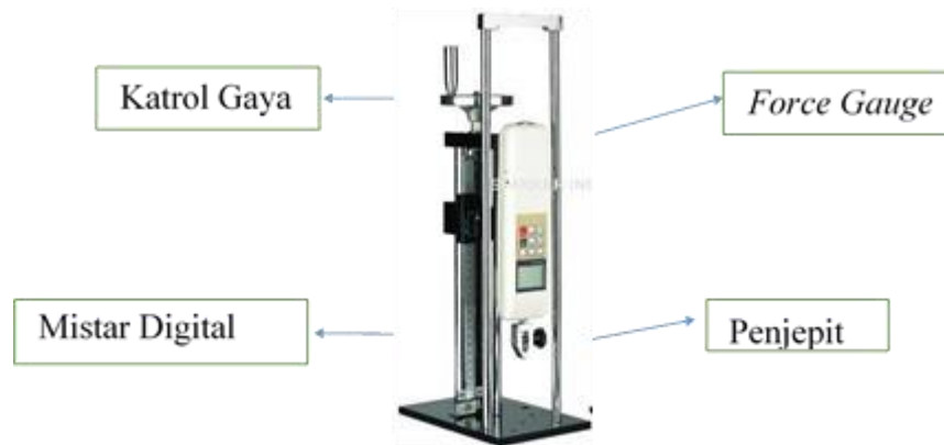
Gambar 3.16 Mesin uji tarik
