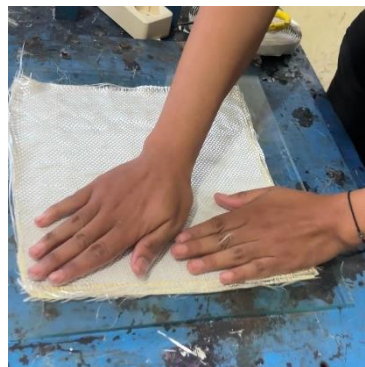
Gambar 3.39 Penyusunan lapisan serat
