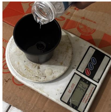
Gambar 3.31 Peracikan resin dan hardener
