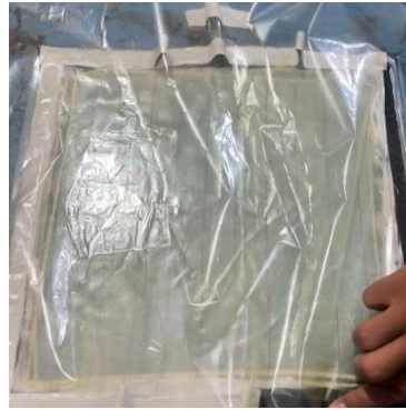
Gambar 3.43 Penutupan sistem vakum
