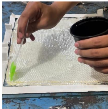
Gambar 3.42 Impregnasi resin dengan metode hand lay
