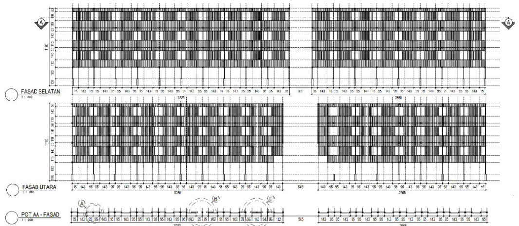
Gambar 5. 21. Detail konfigurasi dimensi adaptive secondary skin pada Fasad Selatan, Utara, dan Potongan Fasad A-A
