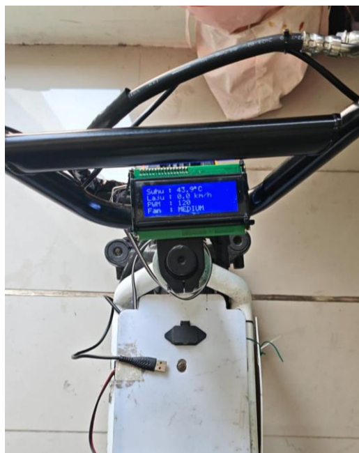
Gambar 4.3 Tampilan Informasi Sistem Pada LCD 20 \times 4
