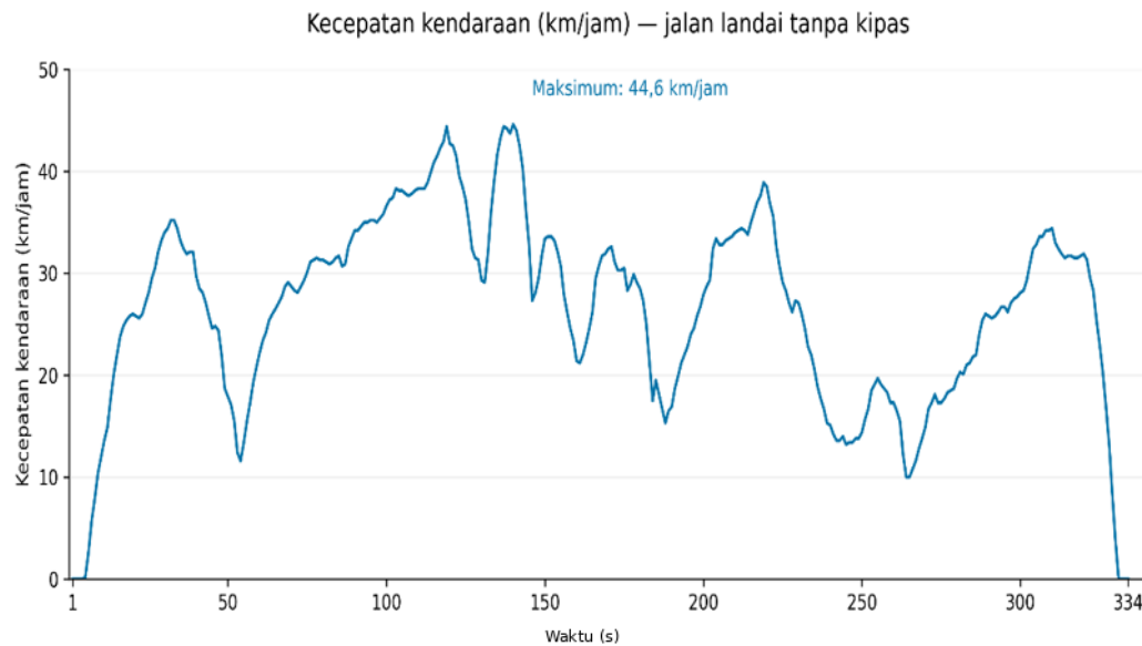
Gambar 4.14 Grafik Kecepatan Pada Pengujian Jalan Landai Tanpa Kipas
