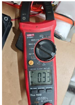
Gambar 4.10 Pengukuran arus masukan PCB pada nilai PWM 120
