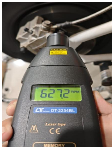
Gambar 4.7 Pengujian Pembacaan Kecepatan
