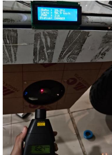
Gambar 4.8 Pengukuran Putaran Kipas Menggunakan Tachometer Hasil pengujian disajikan pada Tabel 4.4.
