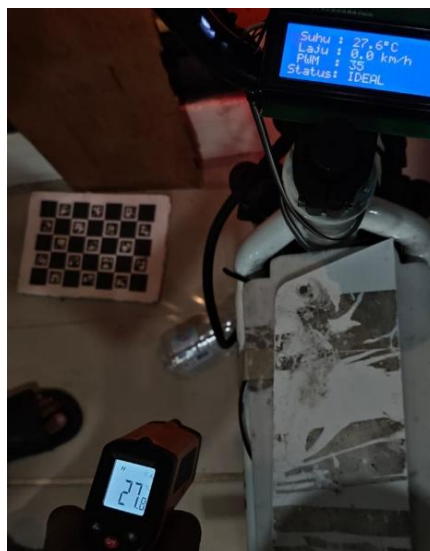
Gambar 4.6 Pengujian Pembacaan Sensor DS18B20 Dan Thermogun
