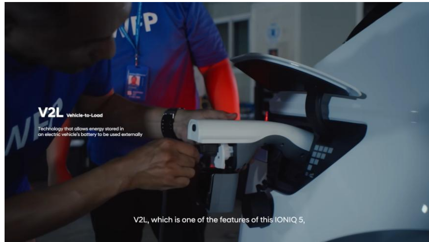
Gambar 2. 8 Demonstrasi Fitur Vehicle-to-Load (V2L) pada Hyundai IONIQ 5 yang Digunakan Petugas WFP untuk Mengisi Daya Perangkat Elektronik saat Operasi Tanggap Darurat
