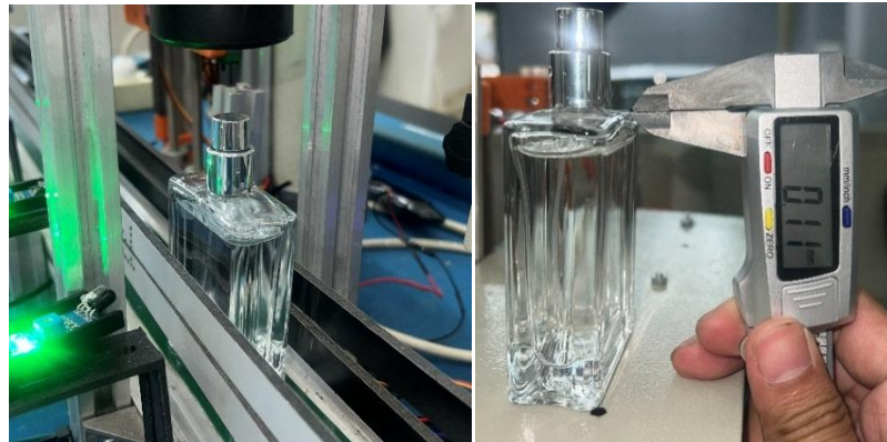
Gambar 4. 6 Pengujian tekanan kerja 60 PSI pada Stasiun Capping (a) Proses Capping Botol Parfum, (b) Pengukuran Celah
