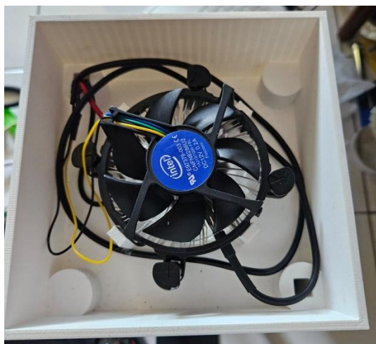
Gambar 4- 8 Tampilan kipas, sensor DS18B20 dan heatsink setelah pemasangan
