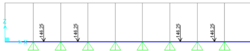
Gambar 4. 24 Diagram Beban Terpusat Akibat Beban Lajur Truk Kondisi 3 (Sumber: Pribadi)
