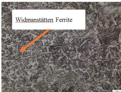
Gambar 4.20. Zona HAZ SS 400 E312
