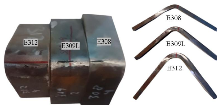
Gambar 4.8. Spesimen Varias E308, E309L, E312 Setelah Uji Tekuk
