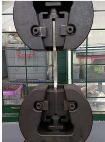
Gambar 4.1 Proses Pengujian Uji Tarik Dengan UTM
