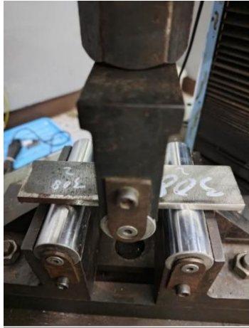
Gambar 4.7. Proses Pengujian Uji Tekuk
