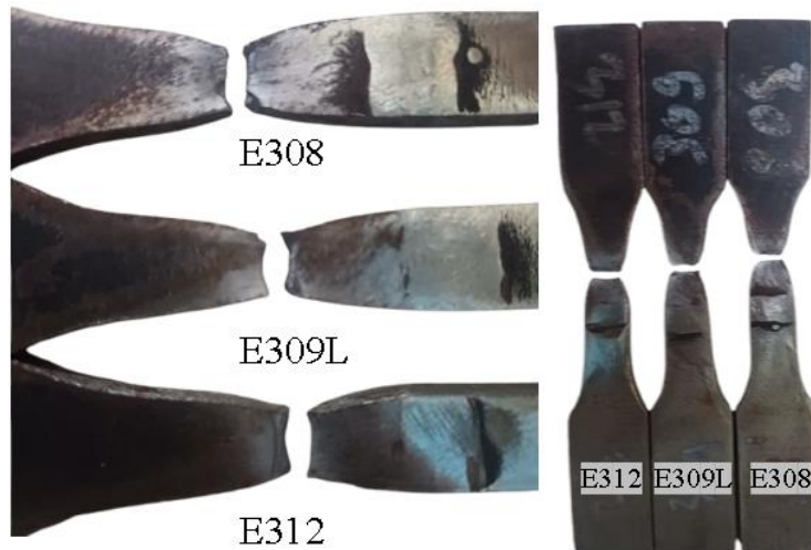
Gambar 4.1. Spesimen Variasi E308, E309L, E312 Setelah Uji Tarik
