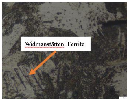
Gambar 4.31 Zona HAZ SS 400 E308
