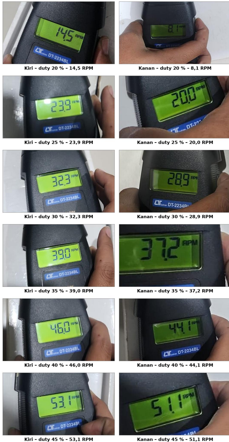
Gambar 4. 3 Dokumentasi pembacaan tachometer optik pada dua belas titik pengujian
