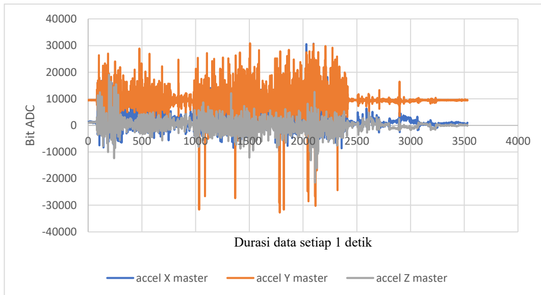
Gambar 4.4 Grafik accelerometer MPU 6050 yang digunakan sebagai data master SKJ 2021
