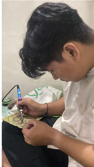
Gambar 4 . 3 Penyolderan Komponen PCB
