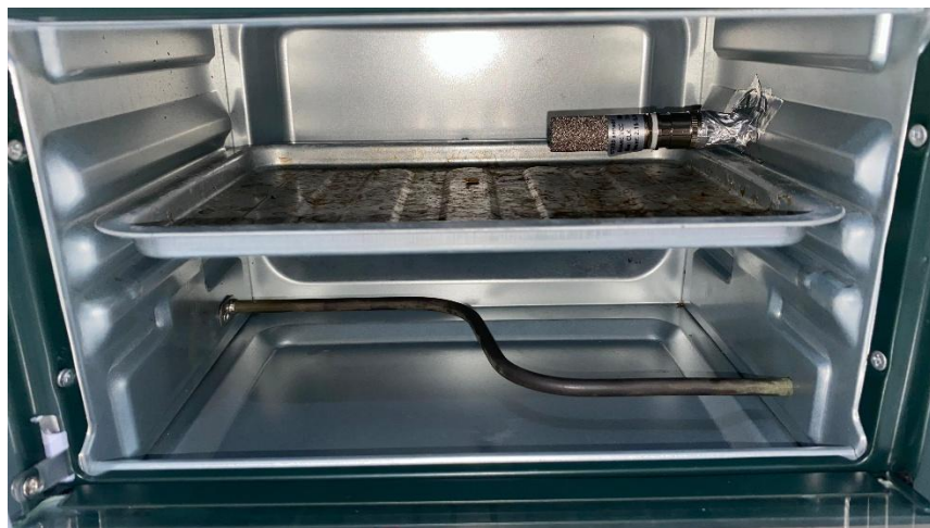
Gambar 4.9 Posisi Penempatan Sensor SHT30 di Dalam Ruang Oven
