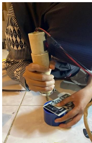
Gambar 4.4 Proses Pengeboran PCB
