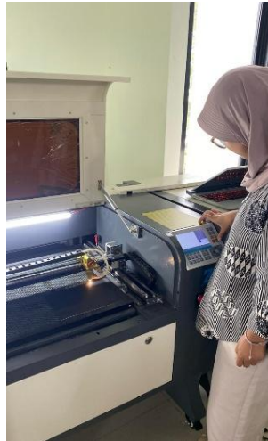
Gambar 4.2 Pencetakan PCB dengan Mesin Laser
