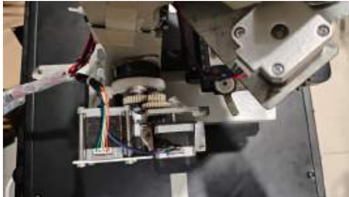
Gambar 4.2 Implementasi mekanisme penggerak fokus pada sumbu Z
