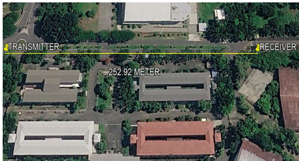
Gambar 5.21 Pengujian Jangkauan Komunikasi LoRa SX1278 Ra-02 Arah Timur
