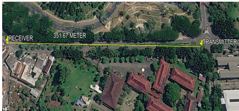
Gambar 5.23 Pengujian Jangkauan Komunikasi LoRa SX1278 Ra-02 Arah Barat
