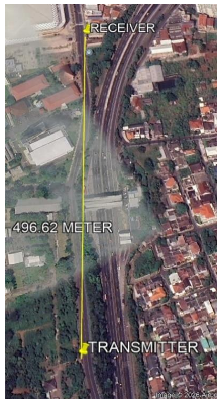
Gambar 5.25 Pengujian Jangkauan Komunikasi LoRa SX1278 Ra-02 Arah Selatan
