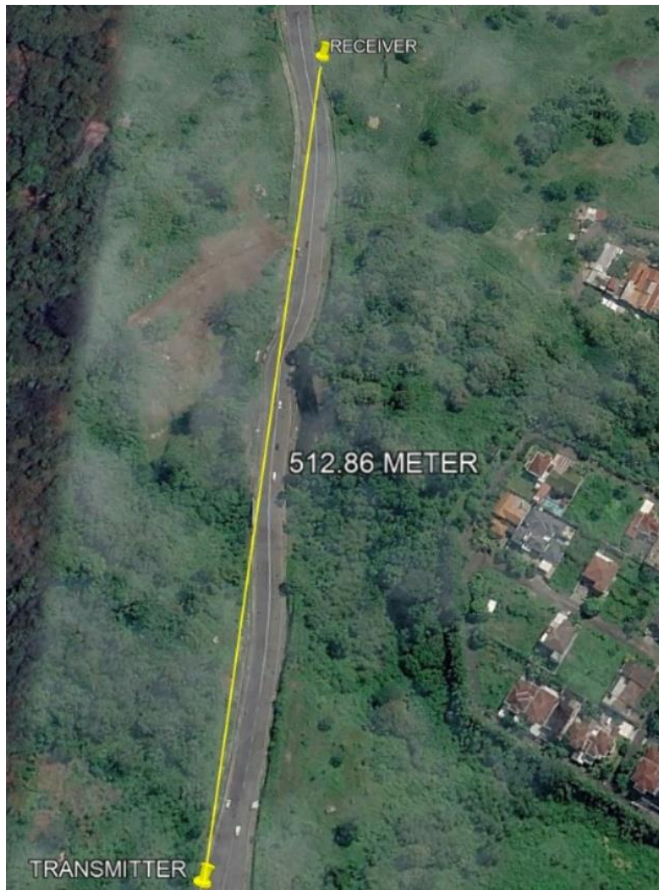
Gambar 5.19 Pengujian Jangkauan Komunikasi LoRa SX1278 Ra-02 Arah Utara
