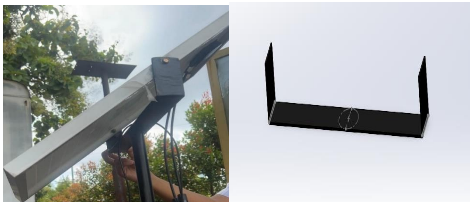
Gambar 4.8 Dudukan Panel Surya
