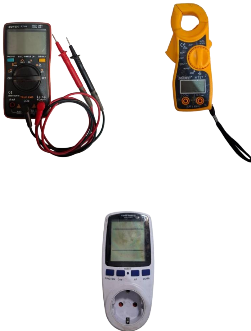
Gambar 4. 3 Multi meter, clamp meter dan display listrik
