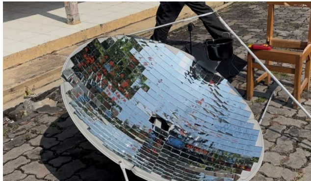
Gambar 4. 4 Hasil pemasangan kaca reflektor pada permukaan parabola
