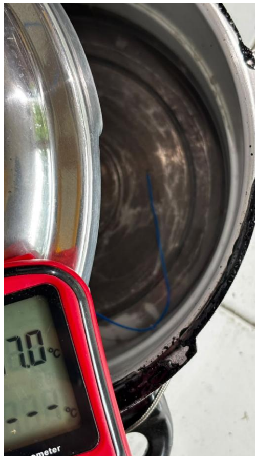
Gambar 4. 8 Cara Pemasangan Probe Temperature
