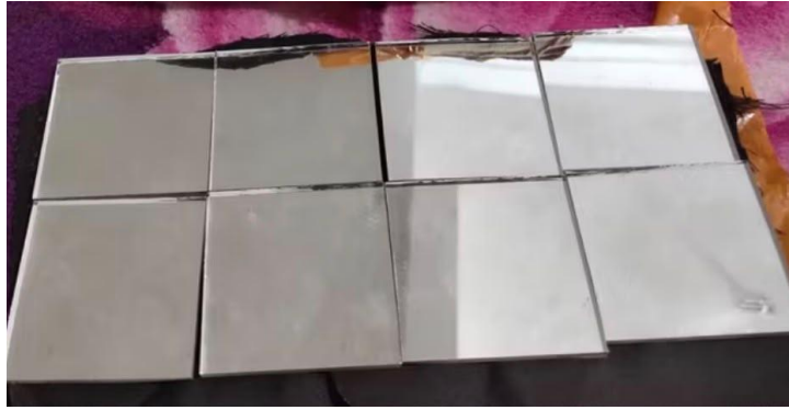
Gambar 4. 2 Hasil pemotongan kaca reflektor berukuran 5 cm × 5 cm
