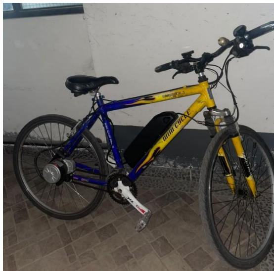
Gambar 4.1 Hasil modifikasi sepeda manual menjadi sepeda listrik
