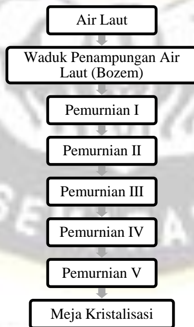
Gambar 5. Pembuatan Garam Secara Sistem Bertingkat
