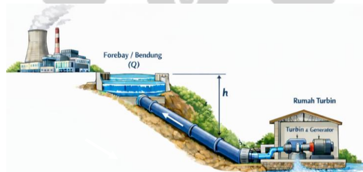
Gambar 2.5 Skematik mikrohidro dengan pemanfaatan buangan air kondensor PLTU Sumber: Diolah Penulis (2026)
