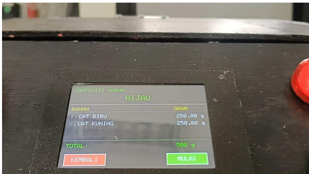
Gambar 4.28 Tampilan Komposisi Pencampuran Warna Hijau
