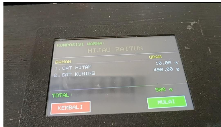
Gambar 4.46 Tampilan HMI Target Komposisi Untuk Warna Hijau Zaitun
