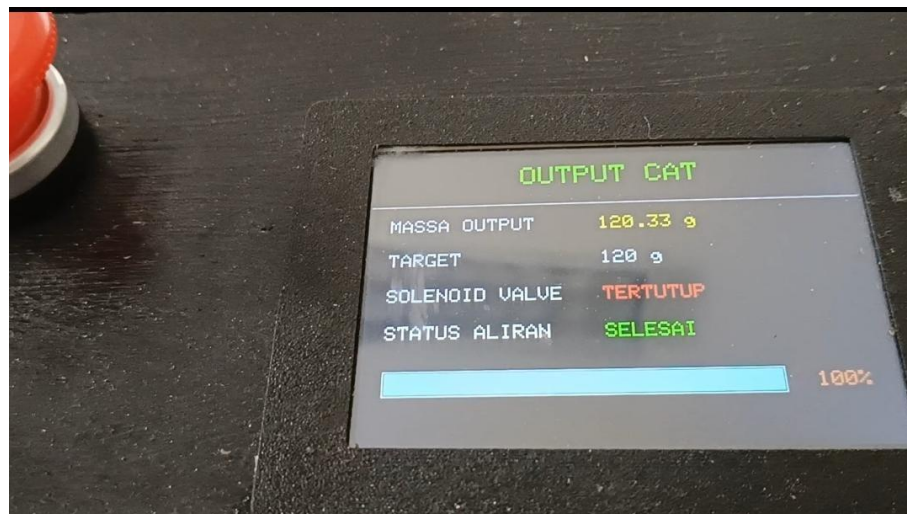
Gambar 4.56 Pembacaan Load Cell 120 Gram, dan Valve Tertutup
