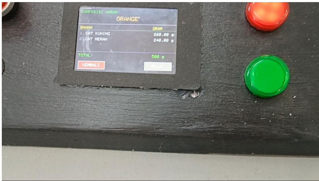
Gambar 4.15 Tampilan Komposisi Campuran Warna yang digunakan
