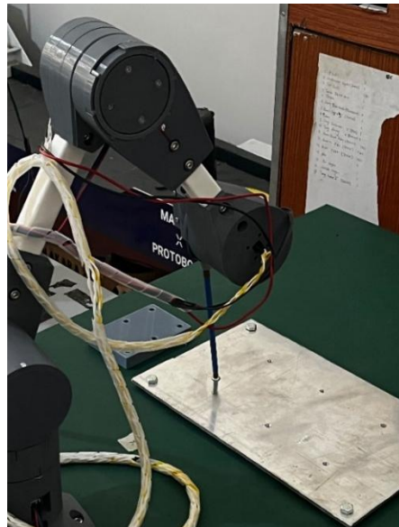
Gambar 4. 10 Proses Pemasangan Baut
