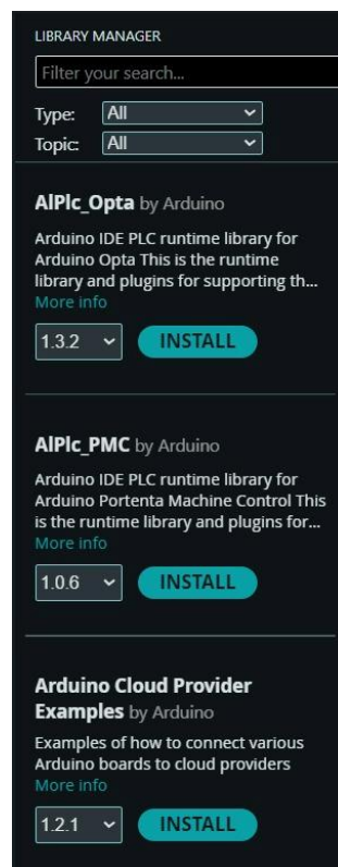
Gambar 2.12 Proses instalasi library yang digunakan pada sistem monitoring panel surya melalui Library Manager Arduino IDE
