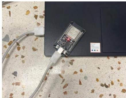
Gambar 2.14 Proses menghubungkan board ESP32 ke laptop menggunakan kabel USB
