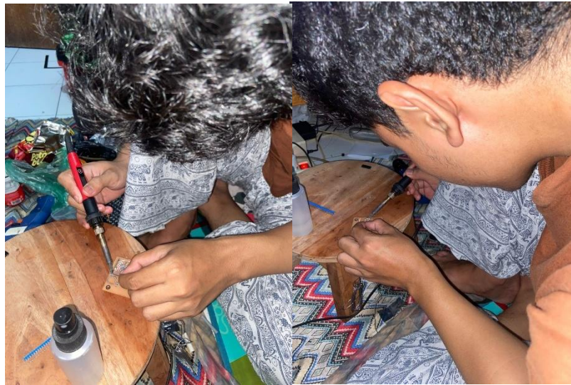
Gambar 4.3 Proses Pencetakan & Penyolderan PCB
