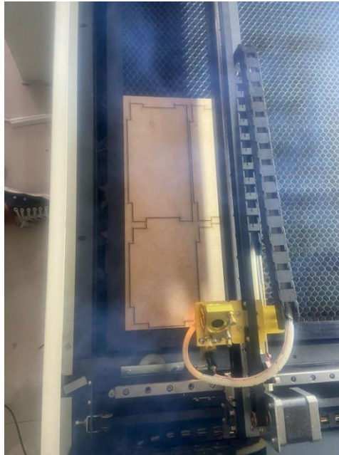
Gambar 4.7 Proses Pemotongan Dinding Ruangan Menggunakan Mesin Laser Cutting
