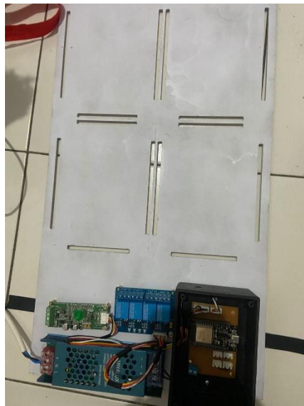
Gambar 4. 8 Hasil Pemasangan Komponen pada Alas Papan Prototype
