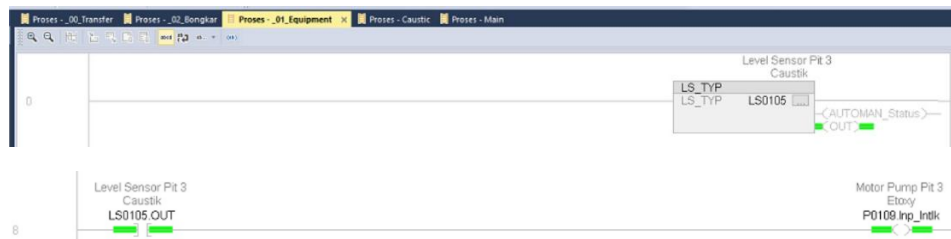
Gambar 3.15 Routine Equipment Rung 0 dan 8 Untuk Interlock Rule 2
