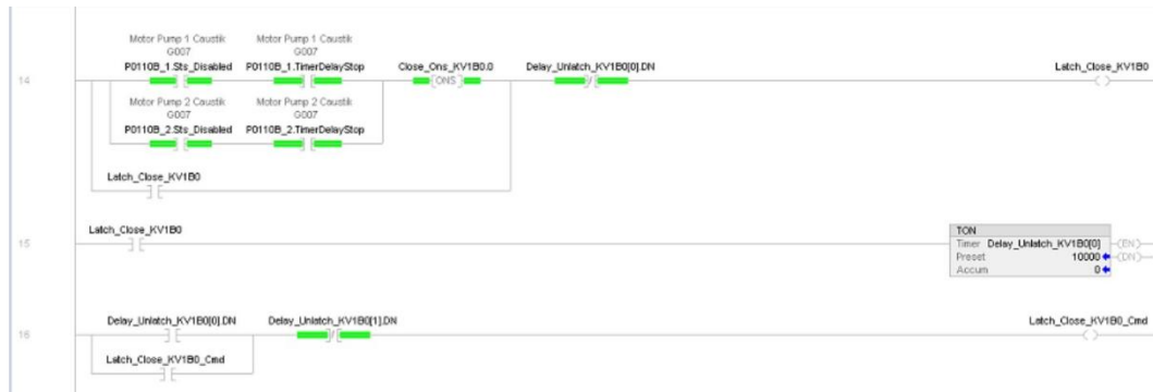
Gambar 3.22 Routine Equipment Rung 14 – 16 Untuk Rule Interlock 7
