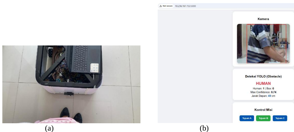
Gambar 4. 30 Pengujian Deteksi Obstacle Human pada Titik B: (a) Kondisi Obstacle Human pada Lingkungan Nyata; (b) Hasil Deteksi YOLOv8n dan Monitoring AGV pada Web
