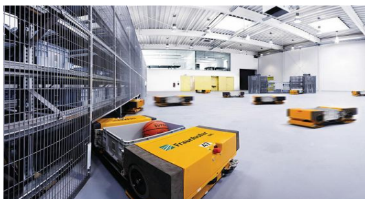
Gambar 2. 2 AGV Swarm di Aula Uji Fraunhofer IMF, Dortmund (2011) [1]
