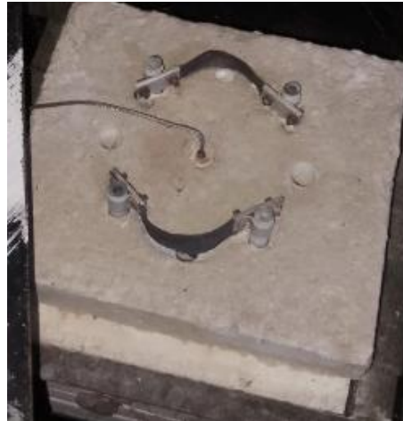
Gambar 2. 10. Alumunium Oksida Sebagai Dinding Ruang Bakar
