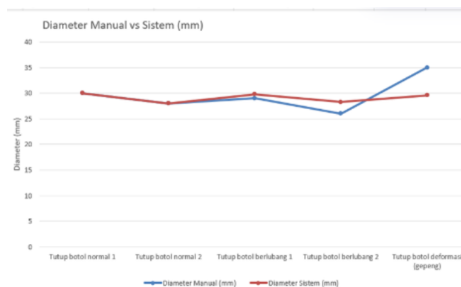
Gambar 4. 49 Grafik Perbandingan Diameter Manual dan Sistem
