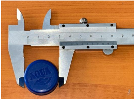
Gambar 4. 46 Pengukuran Manual Objek OK Menggunakan Jangka Sorong
