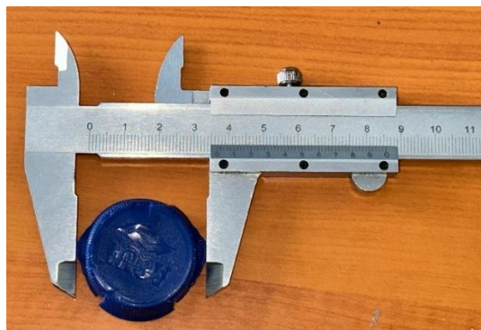
Gambar 4. 48 Pengukuran Manual Objek NG (Deformasi) Menggunakan Jangka Sorong
