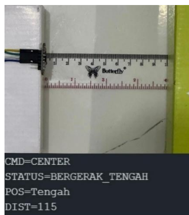
Gambar 4. 9 Pengujian Sensor VL53L0X Posisi Tengah
