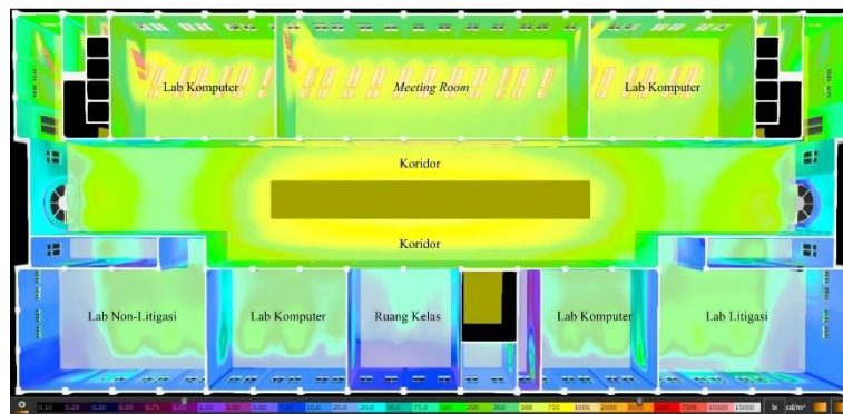
Gambar 5.19 Hasil Simulasi Sirip Vertikal Lantai 3 (16.00)
