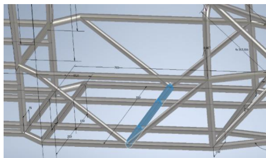
Gambar 4.9 Penambahan pipa bagian tengah
