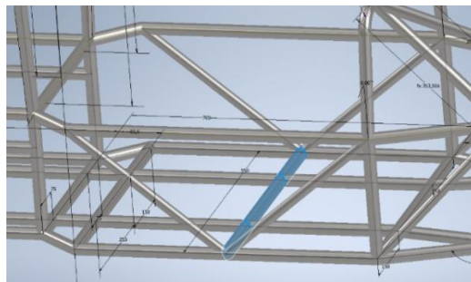
Gambar 4.9 Penambahan pipa bagian tengah
