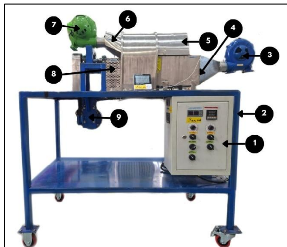
Gambar 4. 1 Hasil fabrikasi test bed dehumidifier
