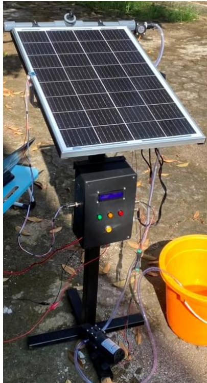
Gambar 4.3 Konstruksi Kerangka Penyangga Panel Surya
