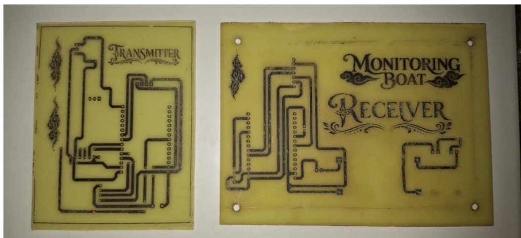
Gambar 4. 4 Hasil Cetak PCB
