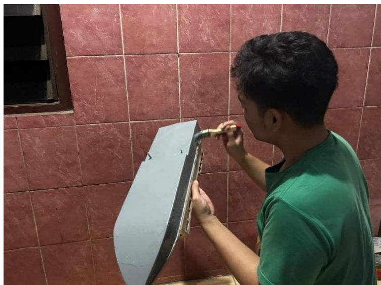
Gambar 4. 10 Pengecatan Bagian Body Bawah Kapal
