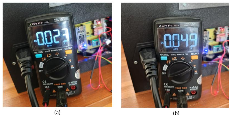
Gambar 4. 13 a.) Pengukuran Arus DC Motor tanpa material bubuk. b.) Pengukuran Arus DC Motor Dengan Material Bubuk
