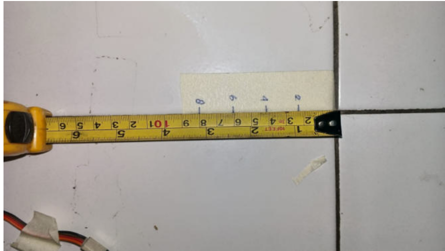
Gambar 5. 3 Penentuan jarak sensor dengan pita ukur
