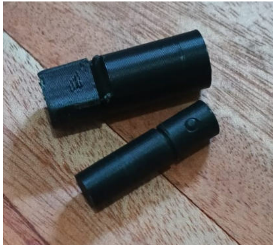
Gambar 5. 8 Kerusakan Coupling Setelah Siklus Pembersihan ke-38
