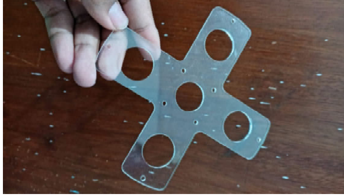
Gambar 4. 15 Hasil pemotongan akrilik dengan CNC laser
