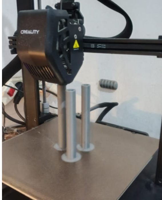
Gambar 4. 18 Proses mencetak spacer dengan mesin 3D Print
