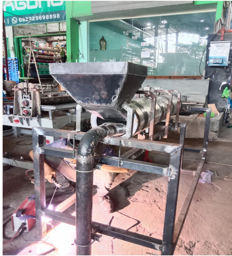
Gambar 4. 2 Proses pembuatan Hopper dan saluran gas
