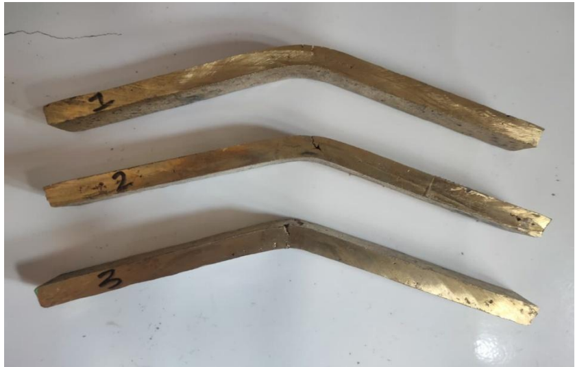
Gambar 4. 27 Hasil Spesimen Uji Bending Kuningan 90% - Aluminium 10% (Sumber: Penulis, 2026)
