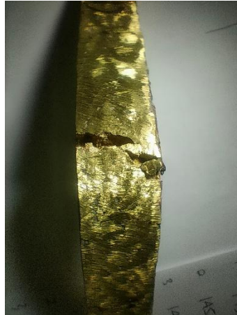
Gambar 4. 31 Visualisasi keretakan spesimen 2 kuningan 90% - aluminium 10% Sumber: (Penulis, 2026)
