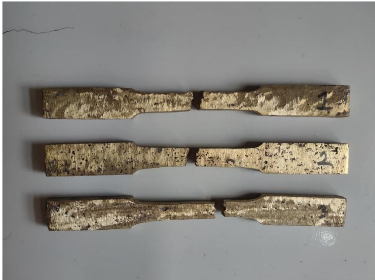
Gambar 4. 10 Hasil Spesimen Uji Tarik Kuningan 90% - Aluminium 10% (Sumber: Penulis, 2026)
