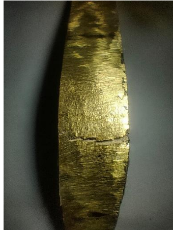
Gambar 4. 33 Visualisasi keretakan spesimen 3 kuningan 90% - aluminium 10% Sumber: (Penulis, 2026)
