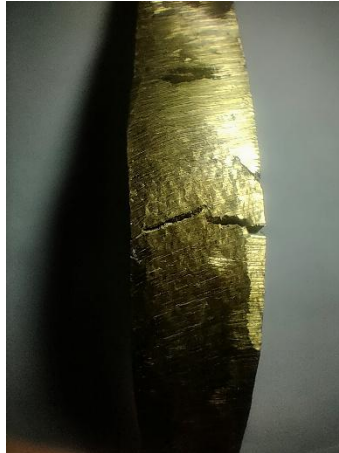
Gambar 4. 29 Visualisasi keretakan spesimen 1 kuningan 90% - aluminium 10% Sumber: (Penulis, 2026)
