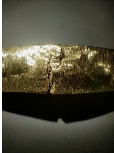
Gambar 4. 24 Visualisasi keretakan spesimen 2 kuningan 100%
