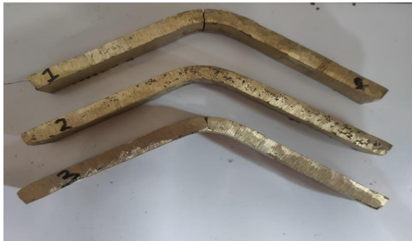
Gambar 4. 20 Hasil Spesimen Uji Bending Kuningan 100% (Sumber: Penulis, 2026)
