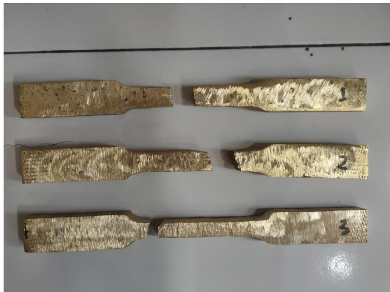
Gambar 4. 3 Hasil Spesimen Uji Tarik Kuningan 100% (Sumber: Penulis, 2026)
