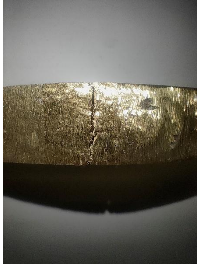
Gambar 4. 26 Visualisasi keretakan spesimen 3 kuningan 100% Sumber: (Penulis, 2026)
