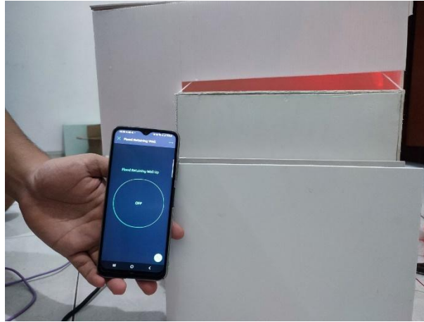
Gambar 4.13 Kondisi Flood Retaining Wall Pada Kondisi Tertutup Sempurna
