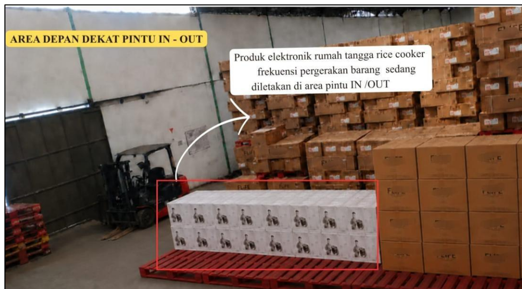
Gambar 1. 2. Penempatan Barang Elektronik dengan Frekuensi Sedang (Medium) di Area Depan Pintu I/O dan tidak sesuai kategori jenis
