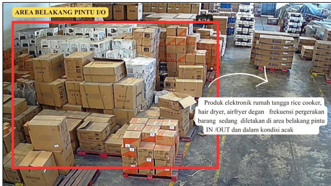
Gambar 1. 3 Penempatan Barang Frekuensi Sedang ( Medium ) di Area Belakang Jauh Pintu I/O
