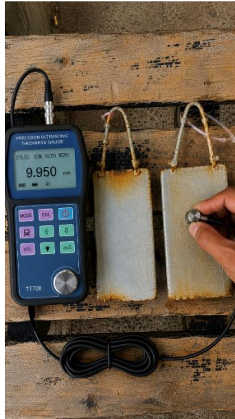
Gambar 4. 8 Pengukuran Ketebalan Spesimen (Sumber: Dokumentasi Pribadi, 2026)
