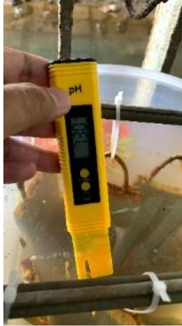
Gambar 4. 7 Pengukuran pH Air Laut (Sumber: Dokumtasi Pribadi, 2026)
