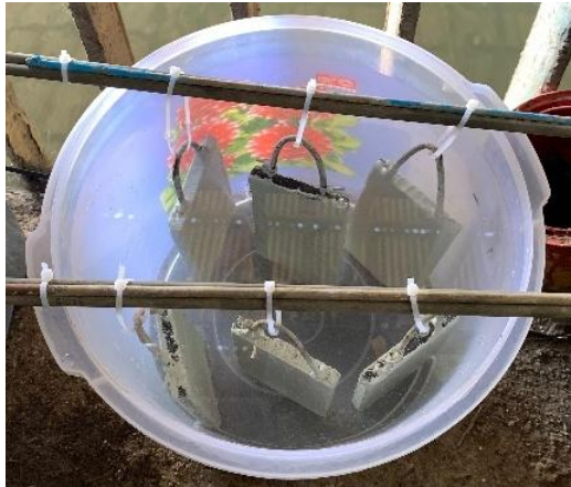
Gambar 4. 5 Proses Perendaman Spesimen (Sumber: Dokumentasi Pribadi, 2026)
