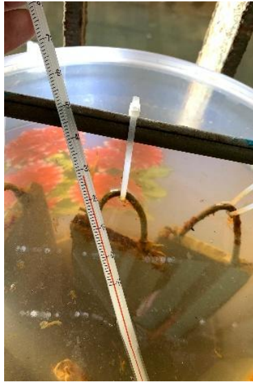
Gambar 4. 6 Pengukuran Suhu Air Laut (Sumber: Dokumentasi Pribadi, 2026)
