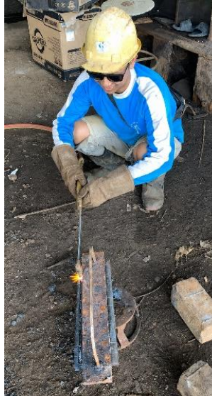
Gambar 4. 1 Proses Cutting Torch (Sumber: Dokumentasi Pribadi, 2026)
