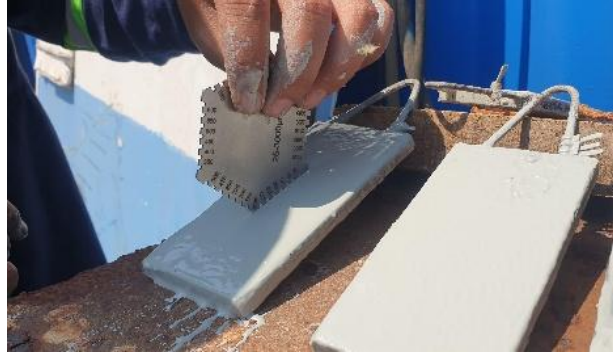
Gambar 4. 4 Pengukuran WFT ( Wet Film Thickness ) (Sumber: Dokumentasi Pribadi, 2026)
